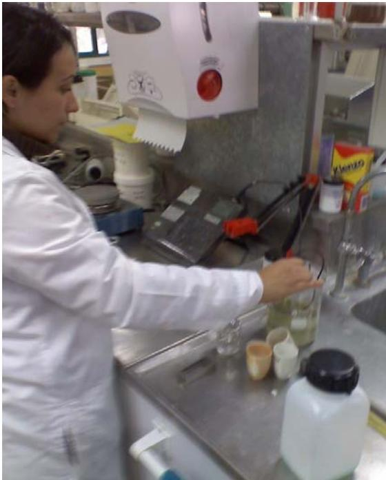
El análisis se realizó con biocatalizador Bactosol CA, basado en enzimas seleccionadas al 5% y dador de ácido y tampón 1g/l PBC. Sobre sustrato de celulosa, con región de aplicación PH 5, con temperatura 60 C, durate 90 min.
