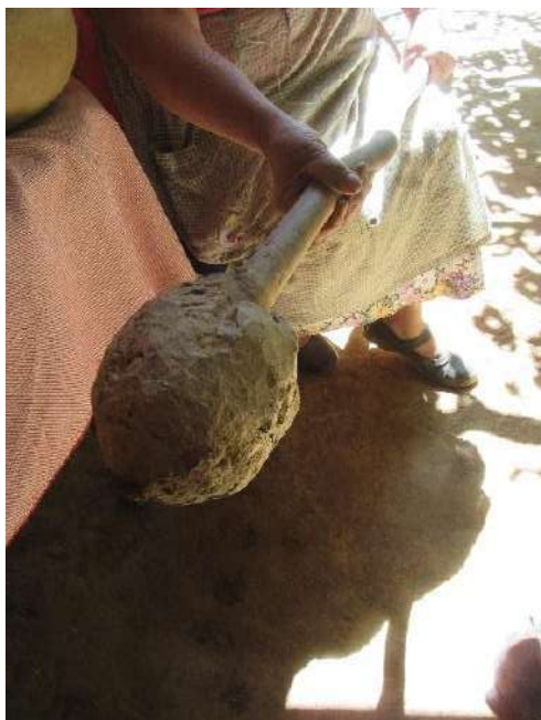
Fotografía 14. Mazo artesanal de madera, para machacar la tierra.
