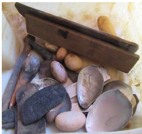
Fotografía 15. Diversas herramientas de una locera: cucharas, cordobán, tablitas, cuchillos y piedras.
